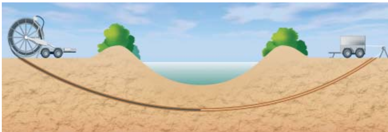
Obr. 27: Metoda řízeného vrtání
