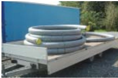
Obr. 37: Kotouč potrubí RAUTHERMEX na přívěsu
